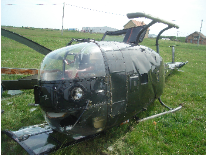
Сл.4. Изглед кабине и структуре трупа хаварисаног хеликоптера YU-HEH на месту удеса
