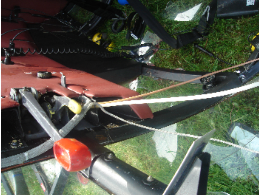
Сл. 14. Детаљ зауставне славине и ручице гаса у кабини хаварисаног хеликоптера YU-HEH на месту удеса
