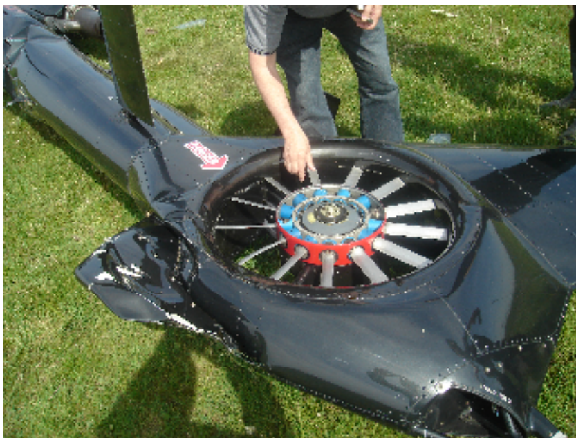
Сл. 7. Изглед фенестрона са репним ротором хаварисаног хеликоптера YU-HEH на месту удеса
