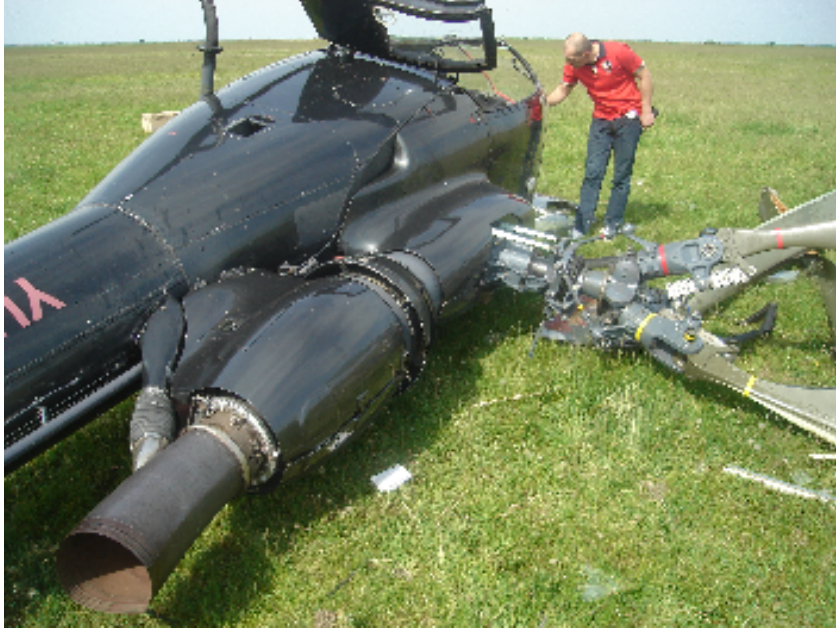
Сл. 8. Изглед лопатица и главчине главног ротора са мотором хаварисаног хеликоптера YU-HEH на месту удеса
