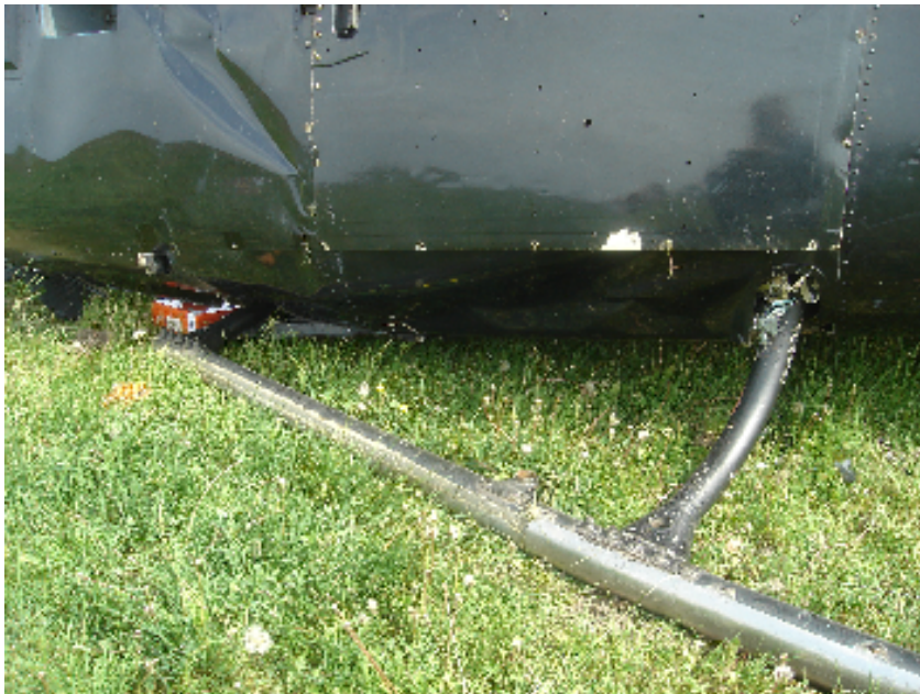
Сл. 11. Изглед поломљене десне скије хаварисаног хеликоптера YU-HEH на месту удеса
