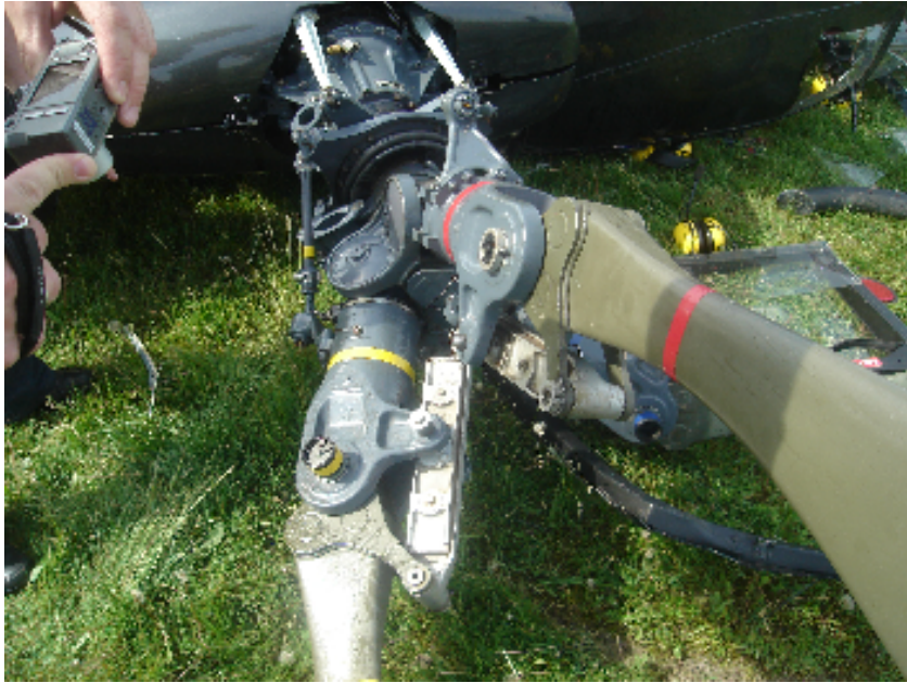
Сл. 10. Изглед лопатица и главчине главног ротора хаварисаног хеликоптера YU-HEH на месту удеса
