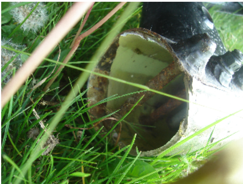
Сл. 12. Детаљ лома поломљене десне скије хаварисаног хеликоптера YU-НЕН на месту удеса
