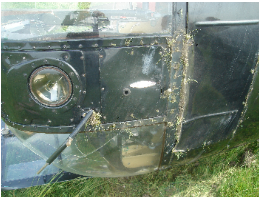
Сл. 5. Деталъ кабине и структуре трупа хаварисаног хеликоптера YU-HEH на месту удеса
