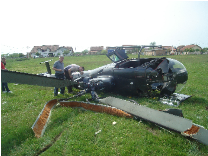
Сл. 9. Изглед кабине и лопатица главног ротора хаварисаног хеликоптера YU-HEH на месту удеса
